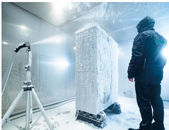
Zespoły badawcze uruchamiają urządzenia w ekstremalnych warunkach atmosferycznych w komorze klimatycznej
